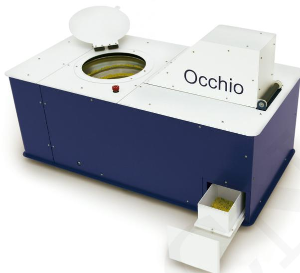
Tecnología de análisis de imagen para aplicaciones en seco: caracterización de tamaño y forma de partículas con computación 3D real. Dispersión primaria vibrante junto con transmisión secundaria por cinta transportadora.
