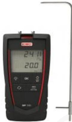
Un Micromanómetro le permite realizar fácilmente mediciones de presión HVAC.
