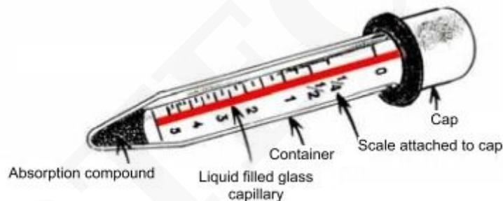
La temperatura del contenedor se estabiliza rápidamente con la temperatura alrededor del concreto. El líquido en el tubo capilar se evapora a una velocidad determinada por la temperatura y el tiempo. El nivel del líquido, legible en la escala, mide de madurez del concreto en unidades M20, lo que es el número equivalente a días de curado a 20°C.
