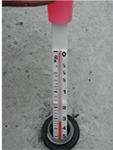
Un tubo capilar de vidrio contiene un líquido para el cual la velocidad de evaporación varía con la temperatura de acuerdo a la ecuación de Arrhenius, que es la misma función para determinar la madurez del concreto utilizando su historial de temperaturas.
