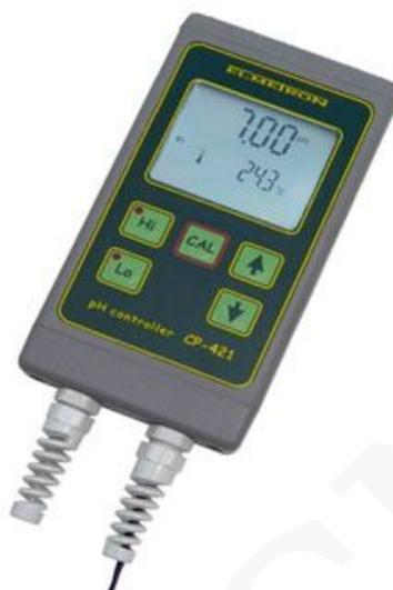
El CP-421 es un dispositivo estacionario que se utiliza para mediciones continuas de pH y temperatura en agua limpia o aguas residuales. Además, permite la regulación del valor de pH con el uso de dos relés (máximo y mínimo). El dispositivo está equipado con pantalla retroiluminada.
