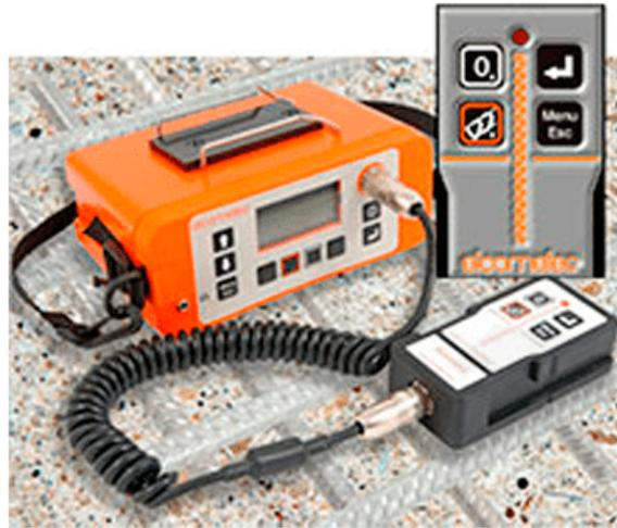
Los instrumentos se basan en la técnica de inducción de pulso. Se aplica un pulso de corriente repetitivo a las bobinas en el cabezal de búsqueda (abajo a la izquierda). Durante cada pulso, la corriente aumenta gradualmente en las bobinas pero se apaga rápidamente.
