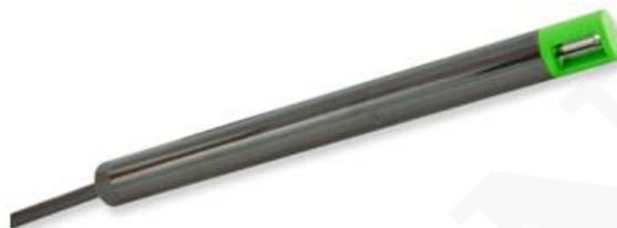
Es una sonda compacta de velocidad del aire para aplicaciones de HVAC. El elemento de detección de flujo integrado VTQ combina las ventajas de la fabricación de película delgada E + E de última generación y la tecnología de moldeo por transferencia más nueva.
