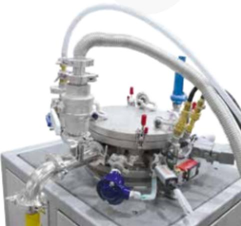
**Retorta con conductos de vacío y de gas protector, conexiones de agua de refrigeración así como termopares**
