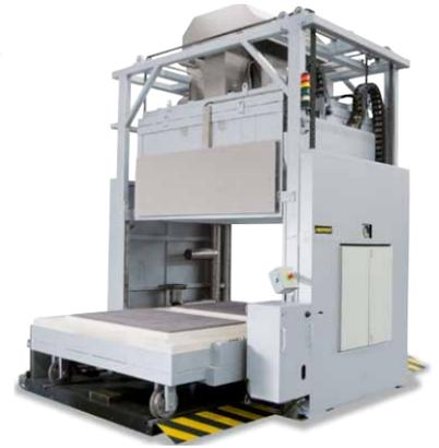
**Horno con sistema de elevación superior**
