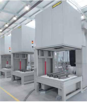
**Instalación de producción, compuesta por 3 hornos de campana con carcasa sellada para el funcionamiento en atmósfera de nitrógeno e**
