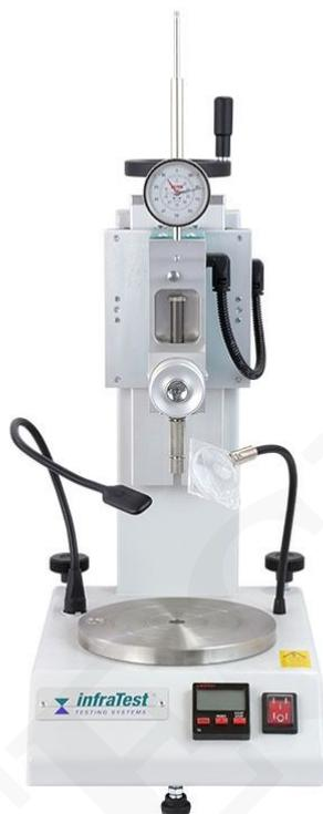
Penetrómetro con controlador de temporizador rígido con placa base, medidor de nivel y brazo móvil del penetrómetro con liberación automática del émbolo mediante un temporizador multifuncional, rango de 0,1 segundos a 99,99 horas.
