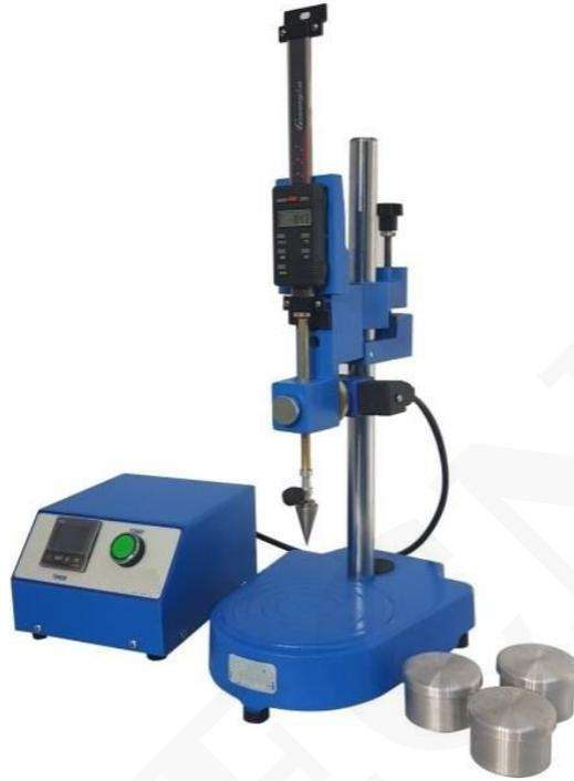
El aparato de penetrómetro digital semiautomático se usa para determinar el contenido de humedad al que pasan los suelos arcillosos de un plástico a un estado líquido y también se usa para determinar la resistencia al cizallamiento no drenado.
