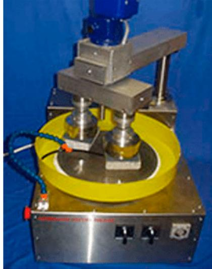
Es un equipo que utiliza de la técnica de lapeado y pulido a máquina para la preparación de superficies planas bañadas
