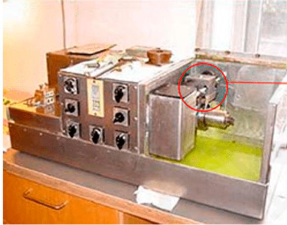
Utilizados por petrógrafos para estudiar la microestructura del hormigón. Como se discutió en ASTM C856, "Práctica estándar para petrográfico Examen de hormigón endurecido," examen de secciones finas de hormigón y materiales relacionados es uno de los métodos más potentes para la determinación y caracterización
