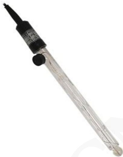
El electrodo de vidrio combinación de **EPS-1** está diseñado para la medición de pH en líquidos que contengan ácidos y álcalis en el gama 0 a 14 pH. Puede ser utilizado para mediciones en líquidos claros.
