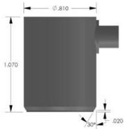
PK15I - Sensor AE de 150 kHz con preamplificador integral de baja potencia
