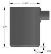
PK6I - Sensor AE de 60 kHz con preamplificador integral de baja potencia
