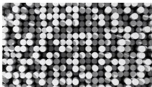
Además, el filtro de plástico poroso auto-sellante, es un tipo especial de filtros de PE sinterizado, se puede utilizar como una opción de diseño como ventilación auto-sellante para aplicaciones de filtrado, también se usa ampliamente en aplicaciones médicas y quirúrgicas.
