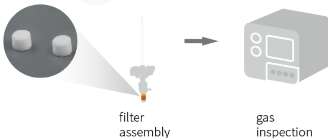
En comparación con otros materiales de ventilación, el material sinterizado de PE tiene la ventaja única de ser auto-sellante. La mayoría de los materiales de ventilación (como las membranas microporosas) solo tienen la función de repeler el agua y
