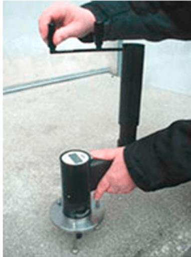
Un adaptador del tamaño apropiado está roscado al perno de anclaje. Un ensamblaje de contra presión se coloca sobre el hormigón de modo que quede centrado con el perno de anclaje
