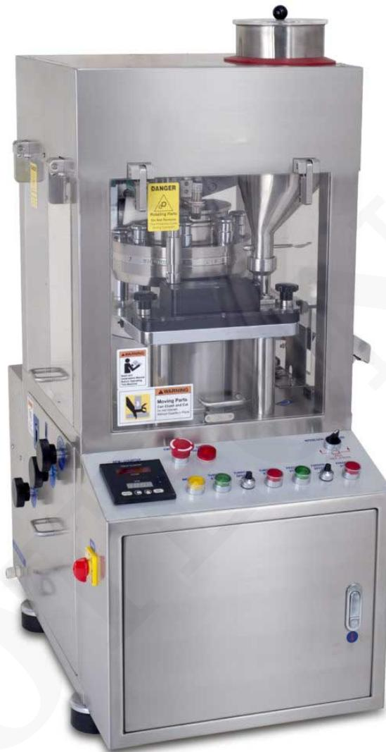
Esta prensa para tabletas de I + D de una cara cumple totalmente con las GMP y los requisitos de seguridad. Todos los ajustes eléctricos se pueden realizar mediante el panel frontal con indicadores en la parte frontal de la máquina.
