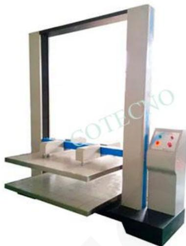
El probador de compresión de cartón se utiliza para medir la resistencia a la compresión del cartón corrugado, el contenedor de envío u otros contenedores de embalaje, y puede mantener la prueba de apilamiento a presión. Los resultados de la prueba pueden ser terminadas con un alto grado de referencia importante, o una base importante para la caja de diseño.
