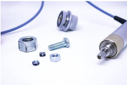
Con este dispositivo, el operador puede, sin fijación y accesorios adicionales, realizar pruebas de dureza de productos que pesen solo 100g o incluso menos.
