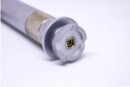
La sonda NOVOTEST T-U2 del probador de dureza UCI tiene una boquilla que ayuda al usuario a mantener la perpendicularidad de la penetración del penetrador en superficies planas, lo que reduce significativamente la posibilidad de error del operador. Además, con una arandela especial, la sonda UCI se puede instalar en superficies radiales, o se puede usar sin boquilla para medir la dureza de piezas pequeñas y ranuras.
