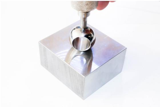
Los propósitos principales del Probador de dureza UCI NOVOTEST T-U2 son productos de forma compleja (dientes de engranajes, cojinetes, etc.) y lugares de difícil acceso que necesitan ser probados (ranuras, superficies de radio, soldaduras y zonas afectadas por el calor, etc.)
