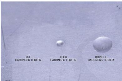
La huella después de medir con el medidor de dureza UCI es muy pequeña, el método se considera el menos destructivo de los conocidos implementados en los probadores de dureza portátiles. Además, la penetración superficial del penetrador permite medir la dureza de las capas endurecidas, como nitruración, cementación, etc.
