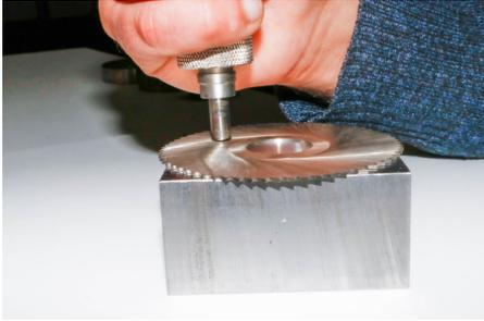
El medidor de dureza UCI NOVOTEST T-U2 se puede utilizar para muestras de 1 mm, y aún menos con una herramienta especial para láminas delgadas.
