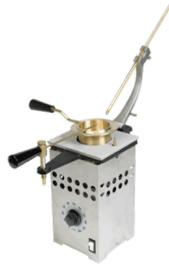
**SKU:** H-2085.4F | **Categorías:** [Asfalto](#), [Ensayos ASTM/NCH](#), [Humboldt](#), [Probadores de punto de ignición](#) | **Etiquetas:** [AASHTO T48](#), [ASTM D117](#), [ASTM D92](#)
