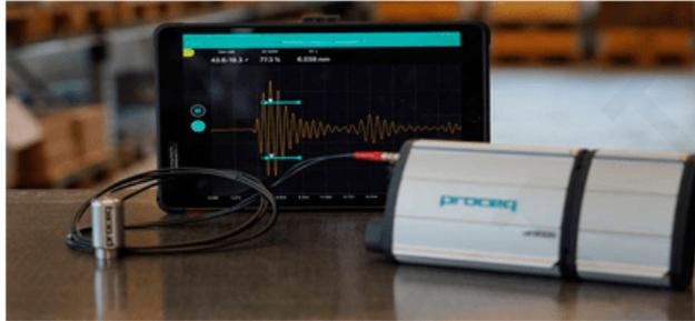
Para medir el espesor, determinar las propiedades del material y detectar defectos en componentes, incluyendo piezas forjadas, compuestos, plásticos y piezas soldadas
