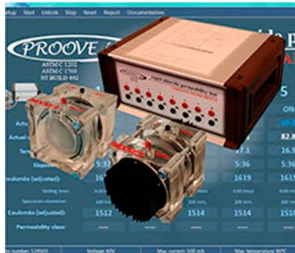
Método de prueba estándar para la indicación eléctrica de la capacidad del hormigón para resistir la penetración de iones de cloruro" es en realidad una prueba de conductancia eléctrica, en lugar de permeabilidad al cloruro, como se dice a menudo.
