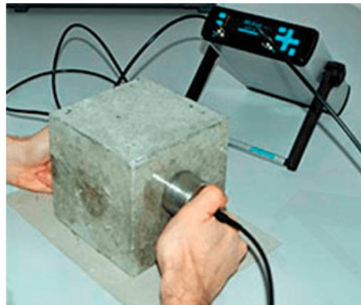
El PUNDIT (Probador de indicación digital no destructivo ultrasonido portátil) se utiliza para medir la velocidad de propagación de un pulso de ondas ultrasónicas de tensión longitudinal.
