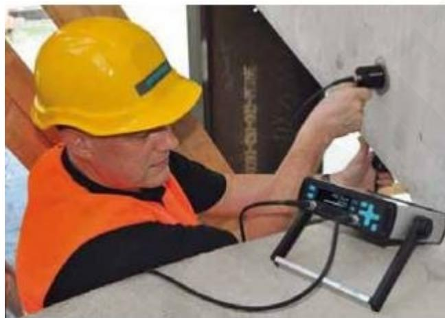
El PUNDIT (Probador de indicación digital no destructivo ultrasonido portátil) se utiliza para medir la velocidad de propagación de un pulso de ondas ultrasónicas de tensión longitudinal. La velocidad del pulso ultrasonido (UPV) que se determina puede usarse para las siguientes aplicaciones:
