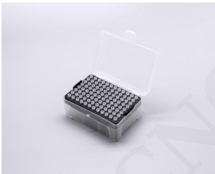
La punta de pipeta universal de diseño único está hecha de material importado de polipropileno (PP) de grado médico, producido en un avanzado taller de purificación de nivel 100.000, con tecnología madura de moldeo por inyección y tecnología independiente de diseño de moldes, rendimiento del producto Superior, que coincide con la mayoría de las marcas de pipetas monocanal y multicanal.
