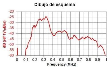
R30-UC - Sensor AE subacuático 200-400 kHz
