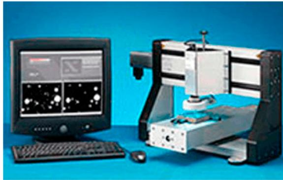
RapidAir es un sistema de análisis de imágenes para la determinación automática del contenido de aire en el hormigón endurecido de acuerdo con el método de desplazamiento lineal en la norma ASTM C457: "Método de prueba para la determinación microscópica de los parámetros del sistema de Vacíos de aire en el hormigón endurecido."
