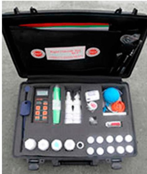
La precisión de los resultados de la prueba RCT comparado con la cantidad conocida de cloruros es tan buena como en el método de valoración potenciométrica de la AASHTO T-260
