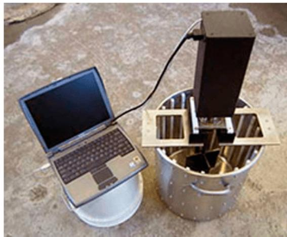
Es un instrumento resistente y portátil para medir las propiedades fundamentales del flujo (reológico) del concreto fresco
