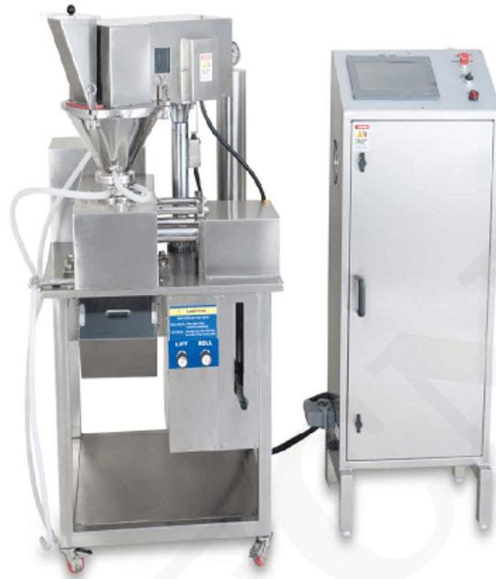
El compactador de rodillos a escala piloto se utiliza principalmente en las instalaciones de I + D para los lotes piloto
