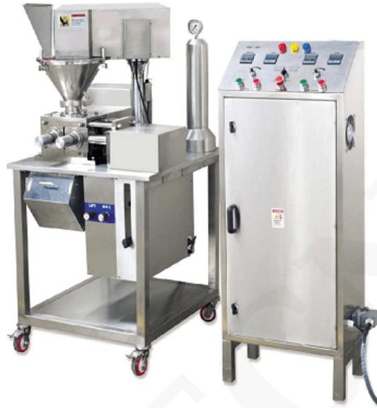
El compactador de rodillos a escala piloto se utiliza principalmente en instalaciones de I + D para los lotes piloto.
