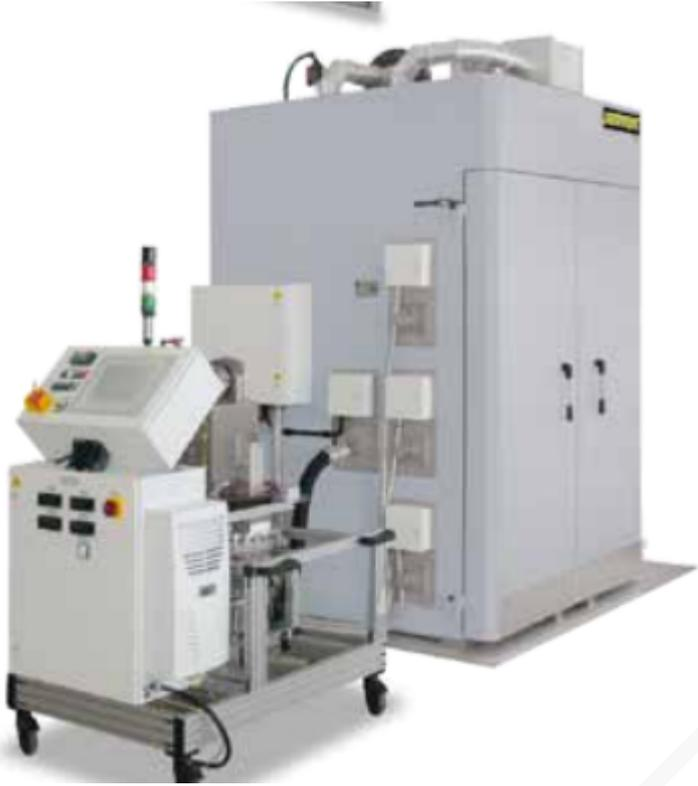
KTR 3100/S para el endurecimiento de materiales compuestos reforzados
