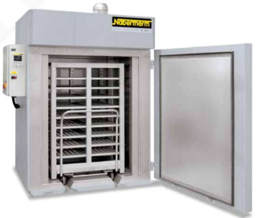
Secadores de cámara KTR 1500 con carro de carga
