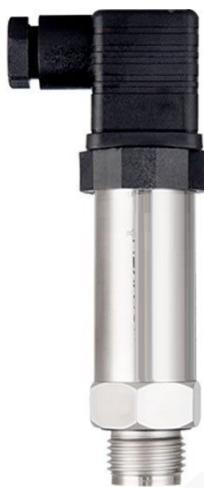
Sensor de presión de diafragma plano con diafragma de descarga sanitaria. Todas las conexiones de proceso del transmisor de presión de descarga están hechas de acero inoxidable, completamente soldadas y aíslan el medio de proceso del instrumento de medición de presión a través de un sello positivo.
