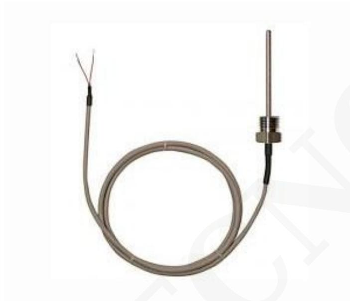
La SFR 50 / SFRD 50 de Kimo es una sonda de temperatura montada en un cable conductor con una punta de contacto y un accesorio de acero inoxidable. Tiene un rango de medición de -50 a + 400 ° C (PT100 y PT1000) y de -20 a + 120 ° C (NTC).
