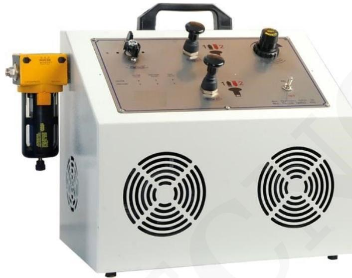
El aparato de desaireación de agua es un equipo compacto y autónomo que puede desairear el agua de manera rápida y eficiente hasta niveles de oxígeno disuelto aceptables para los métodos de prueba geotécnicos. El aparato utilizado en conjunción con el tanque de desaireación. El aire se elimina del agua mediante un sistema de vacío.
