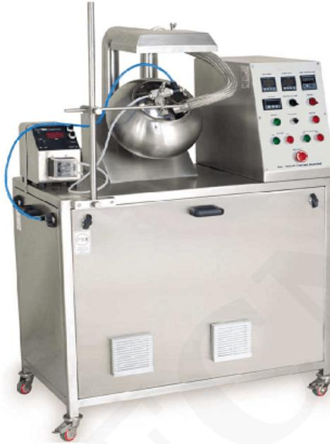
Este es un sistema de recubrimiento de laboratorio autónomo portátil adecuado para recubrimiento de azúcar o película de tabletas, paletas y gránulos, etc.
