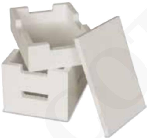
Recipientes rectangulares para los hornos LHTC y LHT,  $T_{\text{máx}} 1600\text{ }^{\circ}\text{C}$  Para aprovechar al máximo la cámara del horno, la mercancía se coloca en recipientes de cerámica. En los hornos se pueden apilar hasta tres recipientes. Los recipientes tienen rendijas para una mejor circulación del aire. La bandeja superior se cierra con una tapa de cerámica
