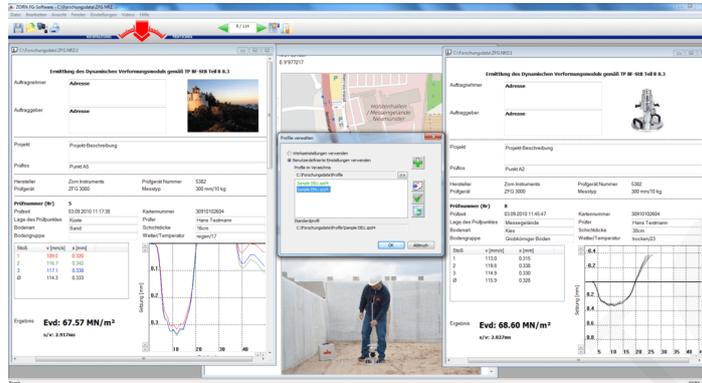
El software ZFG es una aplicación de Microsoft Windows para el procesamiento y análisis de datos de medición (datos brutos) generados con un deflectómetro de caída de peso ZORN INSTRUMENTS.
