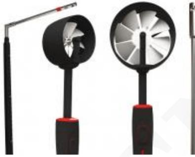
Las sondas de alambre caliente de Kimo miden la velocidad y la temperatura del aire.
