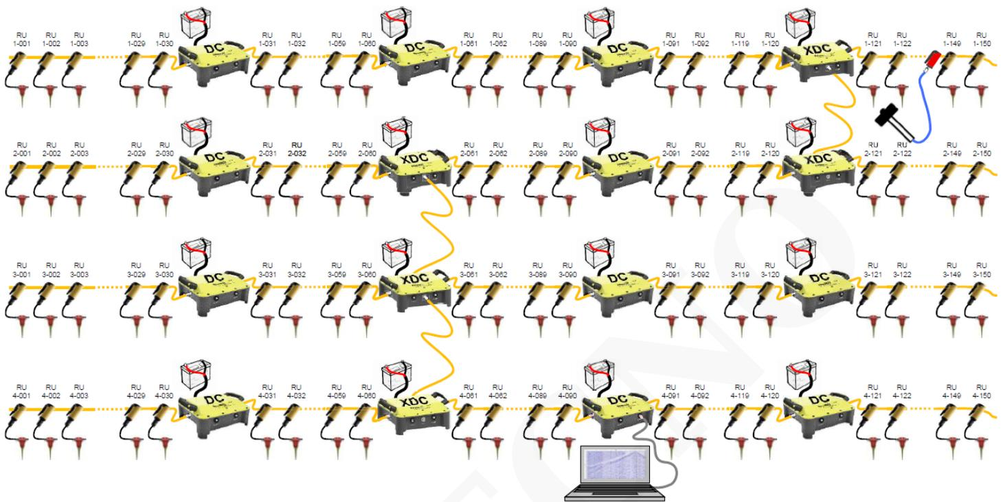
Longitud máxima del cable de datos de 330 m con hasta 50 RU. Máximo de 2 segmentos por CC. PC puede conectarse a cualquier DC en el sistema de adquisición. XDC: una unidad cruzada para la configuración 3D.
