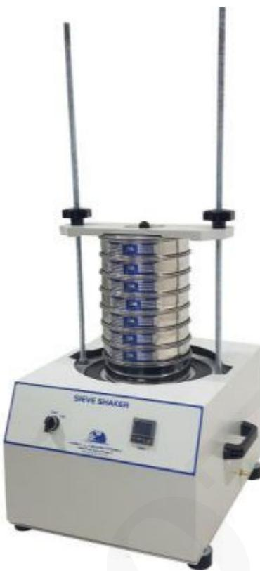
La tamizadora imparte un movimiento circular al material que se está tamizando para que éste realice una lenta progresión sobre la superficie del tamiz. Son ideales para aplicaciones pesadas cuando hay que analizar muestras pesadas o de gran tamaño.
