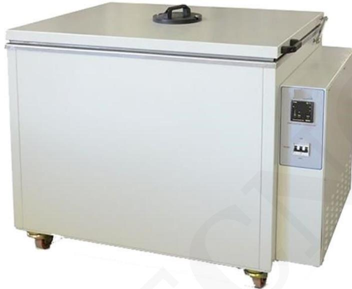
Se compone de un tanque de doble pared totalmente aislado con cubierta, todo de acero inoxidable, exterior de chapa de acero pintada con una capa intermedia de lana mineral aislante y una plataforma perforada de acero inoxidable para la circulación del agua y para soportar las muestras de hormigón. El tanque también tiene una bomba de circulación para proporcionar la misma temperatura del agua en cualquier punto dentro del tanque.
