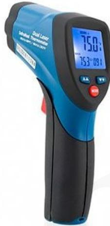
El IRT2 es un termómetro infrarrojo sin contacto, láser dual, de mano con una relación de distancia de 12: 1 al punto y alarmas de punto de ajuste alto / bajo audibles y visibles. Se utiliza para medir y mostrar temperaturas de la superficie dentro del rango de -50 ° C a 650 ° C (-58°F a 1202°F) y tiene una precisión de aproximadamente 1 a 1.5%
