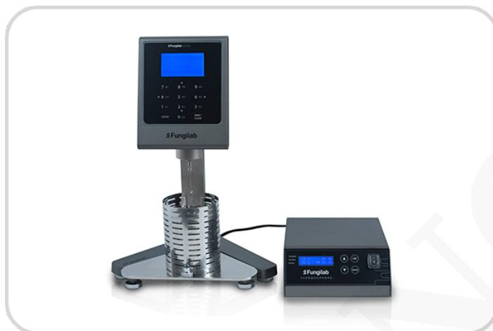
La nueva serie Termosfera ofrece precisión y exactitud para controlar la temperatura de la muestra hasta + 300°C. Ideal para la industria del asfalto y muestras de alta viscosidad.
