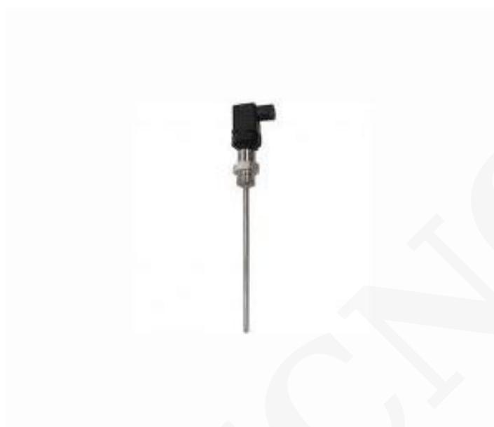
El THIR 50 / THIRD 50 de Kimo es un sensor RTD con cabeza DIN 43650 y elemento resistivo. Tiene un rango de medición de -80 a + 400 ° C (Pt100 y Pt1000) o de -20 a + 120 ° C (NTC).
