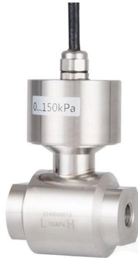
Transmisor de presión diferencial de aire B01060118 DP para sensores e instrumentos limpios de oxígeno que tienen celdas de sensor que están secas o llenas de aceite de halocarbono, que no se quemarán cuando se expongan a una fuente de ignición en un entorno de oxígeno.
