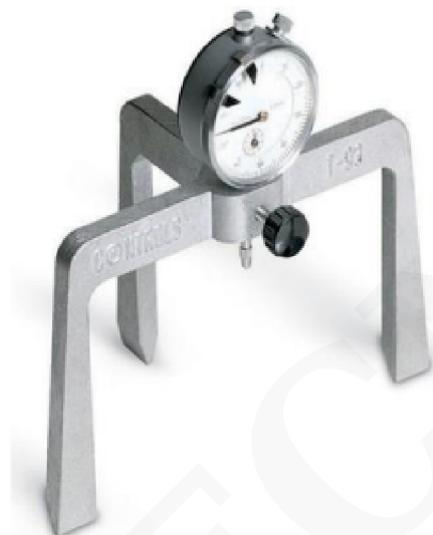
Trípode metálico para medir la expansión en el ensayo CBR.
