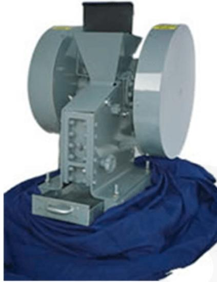
Se obtiene una capacidad de trituración excepcional con un consumo de energía mínimo mediante el principio único de mordaza móvil. El extremo superior de la mandíbula se desplaza en una trayectoria circular impulsada por el eje excéntrico. El extremo inferior oscila a través de un arco corto descrito por la palanca. La acción de la mandíbula resultante es un movimiento hacia adelante y hacia abajo en relación con la mandíbula estacionaria que aplasta la muestra.
