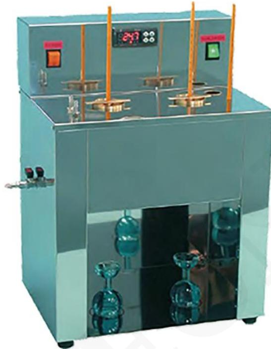
Fabricado en acero inoxidable, el viscosímetro Saybolt se suministra completo con 2 x orificios intercambiables "Furol" y "Universal", baño de aceite, calentador eléctrico con termorregulador digital, llave, soporte para termómetro, agitador, serpentín de enfriamiento, termómetro digital, aceite de transferencia de calor y 2 Piezas Matracas de viscosidad saybolt de vidrio de 60 ml.
