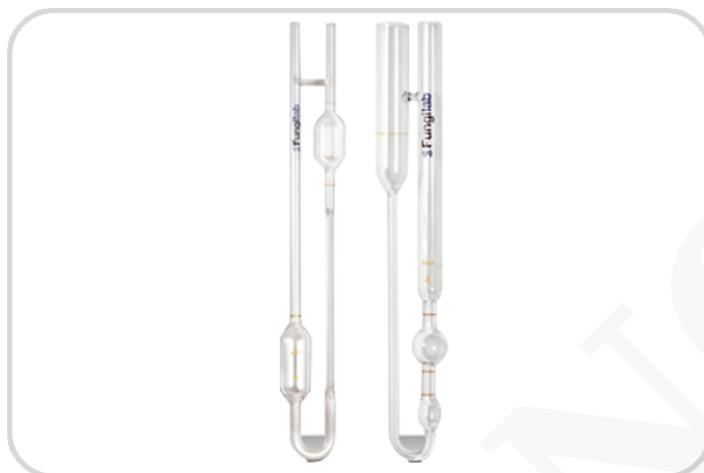
Viscosímetros de flujo inverso en tubo U BS / IP / RF para líquidos opacos BS-IP-RF, ASTM D-445, D446, ISO 3104, ISO 3105 y UNE 400313 Fabricados en vidrio de borosilicato y marcas de sincronización no modificables. Con valor constante a 40°C y 100°C en el certificado de calibración.
